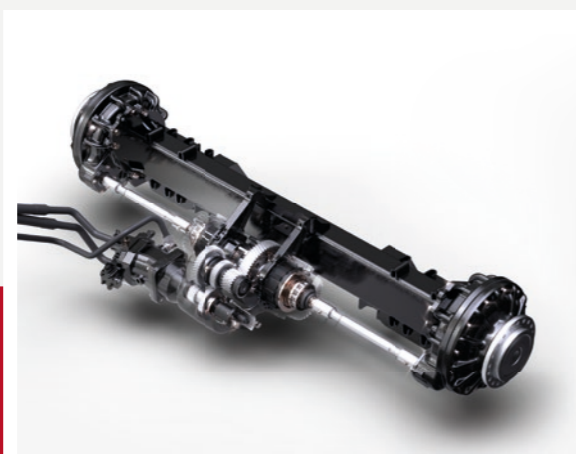
Novo acionamento hidrostático e transmissão para maior tração. Os freios a óleo oferecem potência de frenagem consistente.
